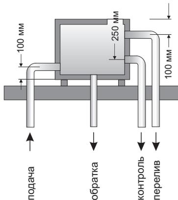
**Рис. 9а. Схема открытого расширительного бачка.**
