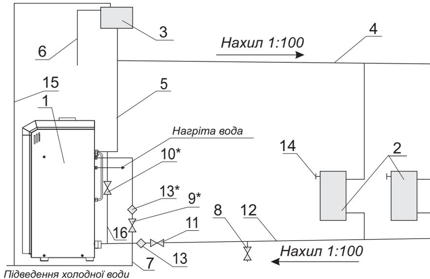
**Рис. 9. Схема монтажу котла в системі опалення з природною циркуляцією теплоносія.**
