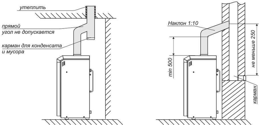
Рис. 4. Схема подключения котла к дымовому каналу и план установки котла
