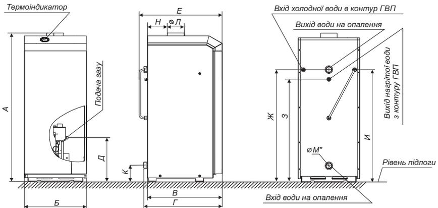
Рис. 1. Загальний вигляд котла
