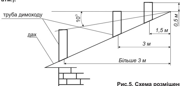
Рис.5. Схема розміщення димоходу
