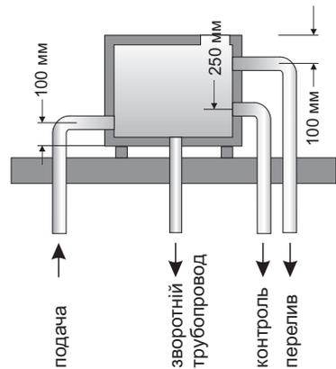
**Рис. 9а. Схема відкритого розширювального бачка.**
