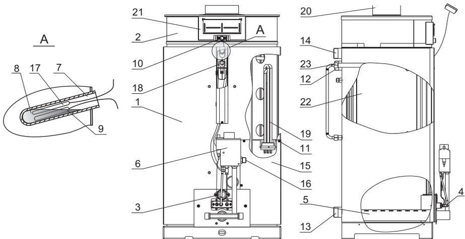
Рис. 2. Схема конструкції котла (декоративне облицювання не показано)
