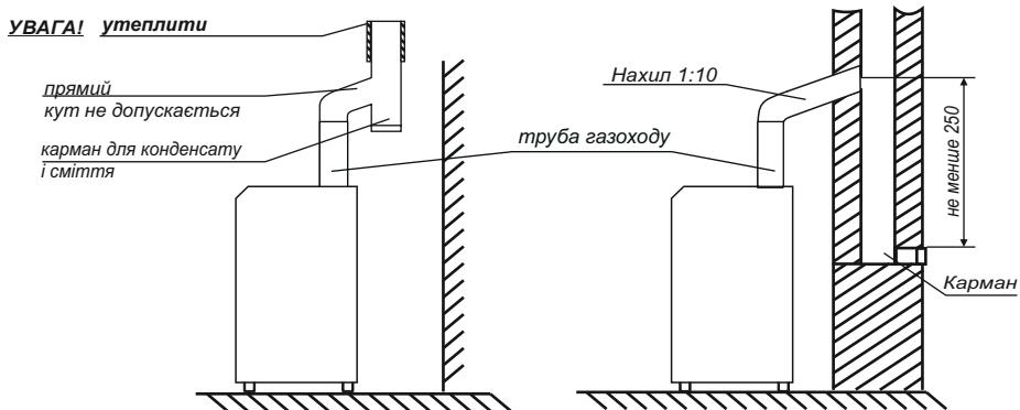
Мал. 4. Схема підключення котла до димового каналу і план установки котла.
