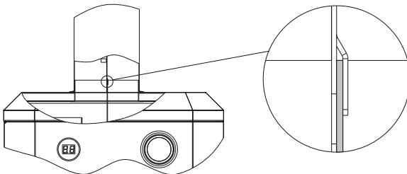
Рис. 3. Схема установки трубы газохода на котел
