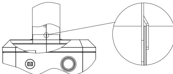
Рис. 3. Схема установки труби газоходу на котел
