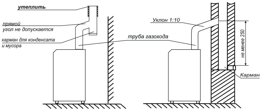
Рис. 4. Схема подключения котла к дымовому каналу.
